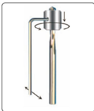
Obr. 7 Nastavení zarážky vrtáku
