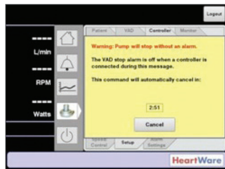
Obrázek 40: Nevyřešený příkaz k zastavení komorového asistenčního zařízení
